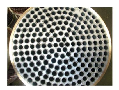
6.- Juntas Toricas son las encargadas de hacer que el haz tubular sea flotante, con lo que reducimos al mínimo las tensiones térmicas. Este sistema de estanqueidad produce que se pueda desmontar con facilidad siempre que procedamos a su limpieza.
